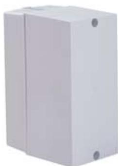
Pour mettre un ventilateur centralisé en marche ou à l'arrêt en combinaison avec une série de clapets motorisés. (Des ventilateurs de plus grande capacité peuvent être commandés à distance via le démarreur ou le variateur de fréquence pour ventilateur Nederman.) Le contacteur de ventilateur comporte une protection thermique moteur. Classe de protection IP66. Bobine 24 V AC, à partir du boîtier de commande ou du transformateur.
