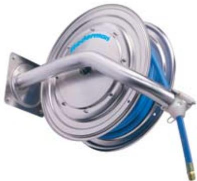
Cet enrouleur de tuyau, fabriqué complètement en acier inoxydable, est spécialement conçu pour l'industrie alimentaire. Il est très facile à nettoyer grâce à ses bords arrondis et comprend une sortie de tuyau facile à démonter, un raccord tournant externe et un nombre minimal d'articulations.
