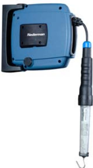
Enrouleur de câble fourni avec lampe baladeuse type LED ou fluorescente. Les lampes baladeuses sont compactes, pourvues d'un interrupteur marche/arrêt, d'un crochet de fixation rotatif, une protection transparente incassable en polycarbonate et d'une poignée ergonomique. L'enrouleur est fourni avec un transformateur intégré.
