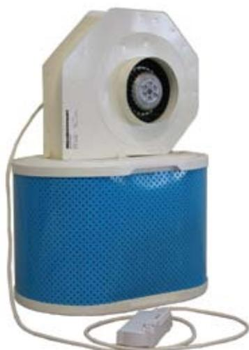
Cette unité consiste en une cartouche filtrante séparée et un ventilateur N3. Elle est conçue pour l'aspiration et la filtration des fumées et des vapeurs émises lors du brasage, du collage ou d'opérations avec des solvants. Prévu pour une utilisation dans différentes combinaisons avec bras FX ou grille d'aspiration vers le bas FD 23.
