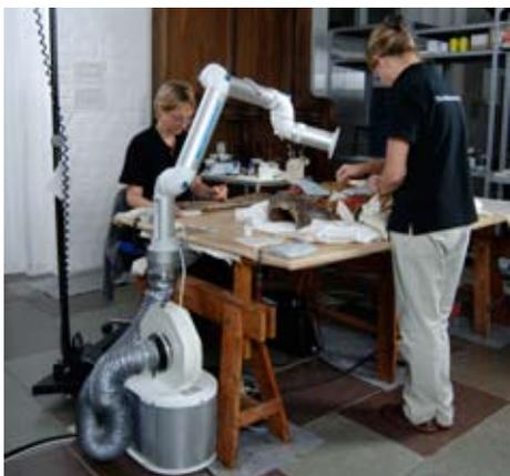
Les kits d'aspiration pour plan de travail, comprennent un (ou plusieurs) Mini Bras d'aspiration FX Standard, avec hotte ou buse, un ventilateur N3 avec variateur de vitesse et un filtre standard (particules, HEPA et Charbon actif), un ou plusieurs tuyaux, des pièces de raccordement et des pinces de table.
