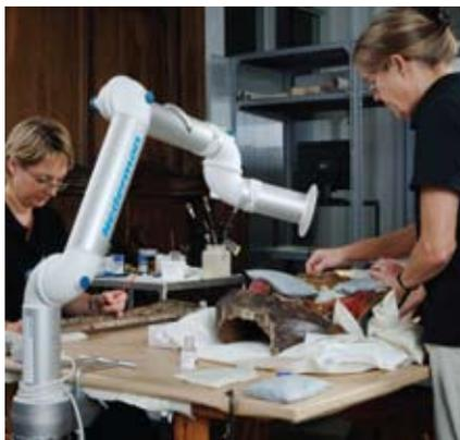
Les systèmes d'aspiration Nederman pour plan de travail peuvent être utilisés dans tout type d'environnement en partant des postes d'assemblage où des fumées de brasage sont aspirées jusqu'aux laboratoires où la protection contre des gaz fortement corrosifs ou nocifs est vitale.
