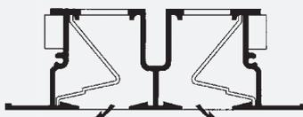
► Version 2-fente du MTL, bien insérer les déflecteurs du côté droit et gauche des fentes respectivement.
