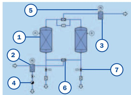
► Le sécheur par adsorption sans économiseur d'énergie travaille sur la base d'un contrôle de cycle prédéterminé pour lequel le sécheur est conçu pour une charge d'humidité maximale. De là, la consommation d'air comprimé utile à la régénération du sécheur est constante.
