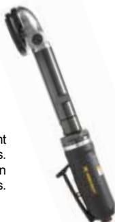
Tronçonneuse 370 mm de long. Diamètre 100 mm. Convient aux zones particulièrement profondes et difficiles d'accès. Poignée composite contre le froid. Blocage de l'arbre pour un changement aisé de la meule. Carter orientable en 11 positions. Livrée avec 5 disques de tronçonnage.
