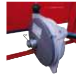
Équilibreur de charge pour le maintien de la clé à chocs
