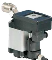
Réservoir interne avec contrôle de niveau électronique à flotteur - Filtre amont incorporé. Diode de contrôle alimentation - Diode de contrôle purge - Alarme de dysfonctionnement. Fonction test - Alimentation 230 V ca - Raccordement électrique par P.E. PG 9. Montage horizontal uniquement - PS : 0,2-16 bar TS : + 60 °C. Fiche technique : **FT 42002**.
